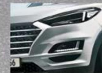
Светодиодная головная оптика (LED)
